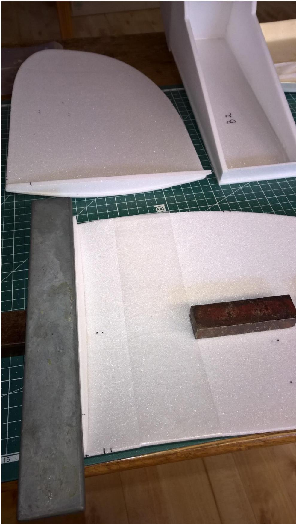
Die Wurzelrippen werden mit Hilfe der Winkelschablone an die vorgebogenen Tragflächenhälften geklebt. Anschließend werden die im Winkel plan geschliffenen Tragflächenhälften an den Wurzelrippen verklebt. Nach einkleben der äußeren Rippen sind die Tragflächen fertig.
