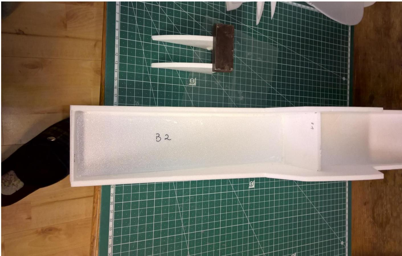
Hier ist auch der hintere Boden verklebt. Um das Eindringen von Wasser zu verhindern wird die Verklebung noch mit Epoxydharz und Microballons verstärkt. Der Motorträger wird ebenfalls mit dem Epoxydharz – Microballons Gemisch verstärkt.
