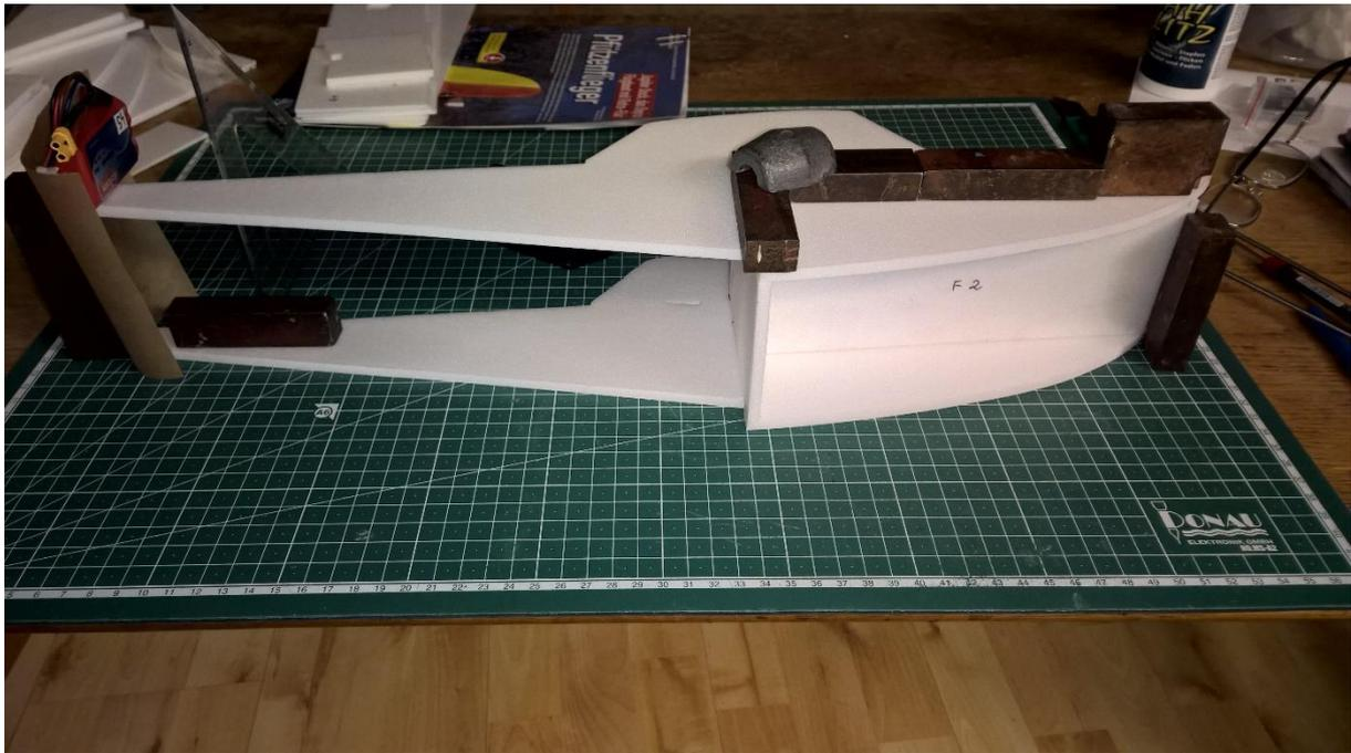
Der Zusammenbau wird mit den beiden Spanten und dem mittleren Boden begonnen. Den Kleber in diesem Falle nicht ablüften lassen damit alles richtig winkelig ausgerichtet werden kann. Nachteilig ist halt dass in diesem Falle länger auf die Trocknung der Klebestelle gewartet werden muss.
