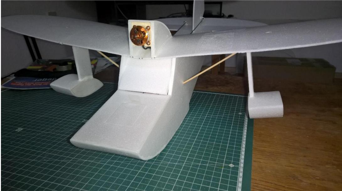
Die Schaschlik Spieß Streben werden provisorisch angepasst. Die Stützwimmer werden exakt ausgerichtet. Wenn alles passt können die Stützwimmer und die Streben verklebt werden.
