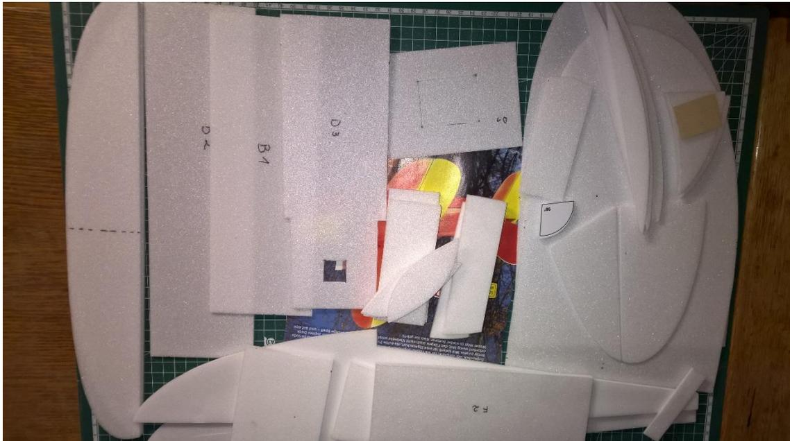
Jetzt sind alle Teile ausgeschnitten. Alle Verklebungen werden mit UHU Por gemacht.
